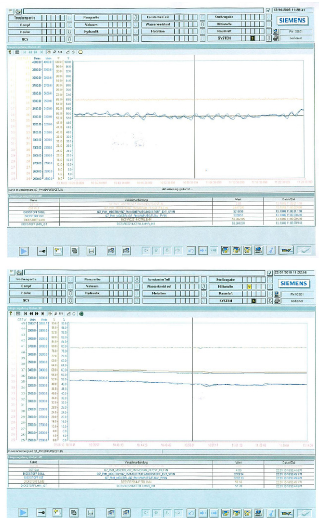
Abb. 3: Stoffmengenvergleich altes Ventil (oben) mit starken Schwankungen und neues Ventil mit Präzisionsantrieb (unten)
