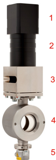
Abb. 1: Ausgelegt auf hohe Regelpräzision – das Kugelsektorventil (4) ist mit einem Servomotor (1) und einem Planetengetriebe (2) kombiniert. Mit dem Absolut-Drehwinkelgeber (5) wird die exakte Position des Kugelsektors kräftefrei erfasst und an die Steuerung zurückgemeldet. Mit der Handnotbetätigung (3) kann das Ventil auch bei Stromausfall positioniert werden.
