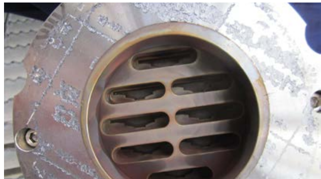
Abb. 7 Das Ventil wurde nach 1 Jahr demontiert und überprüft und keinerlei Schaden festgestellt.
