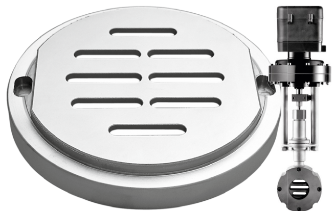
Die aufeinander gleitenden Schlitzscheiben bilden das zentrale Drosselorgan in Gleitschieberventilen. Da hier auf metallische Sitze verzichtet werden kann, entstehen auch keine Riefen, die in traditionellen Ventilen sehr schnell zu teuren Undichtigkeiten führen.
