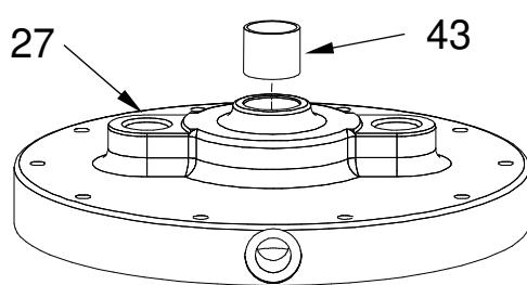
2. DU-buchse (43) in die untere Membranschale (27) einpressen.
