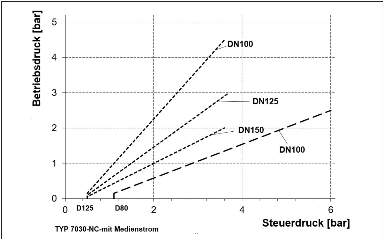
Einsatz vorzugsweise bei gasförmigen Medien, bei Flüssigkeiten sind Schließschläge möglich
